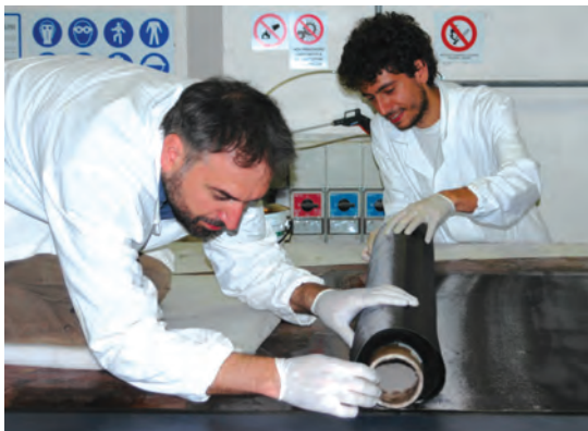
4. Fasi della laminazione della masonite con pelli di fibra di carbonio
