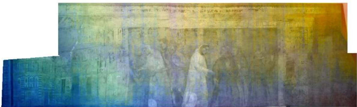
Fig.8 Termogramma nell'infrarosso termico. Rappresentazione con fusione dell'immagine termica sull'immagine fotografica
